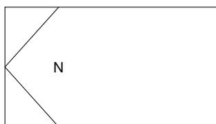
Abbruchanweisung – N ist der Bezeichner des zu verlassenden, umgebenden Strukturblocks. Als nächstes wird der auf N folgende Strukturblock verarbeitet.
