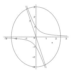
Startwerte:  $\begin{pmatrix} 2.5 \\ 0 \end{pmatrix}, \begin{pmatrix} -1 \\ 3 \end{pmatrix}, \begin{pmatrix} -2.5 \\ 0 \end{pmatrix} \text{ und } \begin{pmatrix} 1 \\ -3 \end{pmatrix}$   $f(x,y) = \begin{pmatrix} y^2 + 3yx - 1 \\ y^2 + 1.5x^2 - 9 \end{pmatrix} \rightarrow f'(x,y) = \begin{pmatrix} 3y & 2y + 3x \\ 3x & 2y \end{pmatrix}$  (2)
