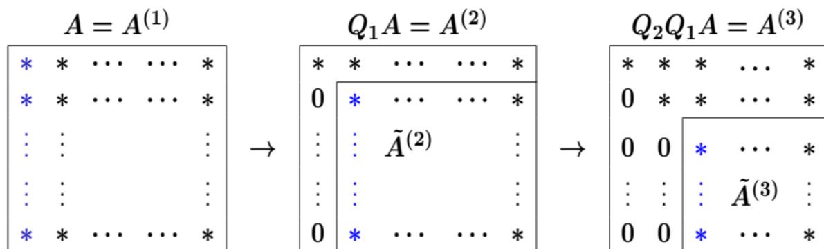
$$Q_{n-1} \dots Q_2 Q_1 A = R, \text{ bzw. } A = Q_1^T Q_2^T \dots Q_{n-1}^T R = QR$$
